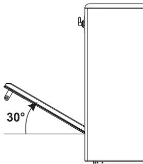
3. Pour remonter la porte, introduisez les charnières dans les fentes prévues à cet effet sur le four en vous assurant que les rainures **A** sont complètement posées contre les fentes. Abaissez la porte vers le bas puis, après l'avoir positionnée, extrayez les crochets de blocage des trous des charnières.
