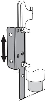
7. Déplacez la bride sur le mur et marquez la position des trous à réaliser dans le mur.
