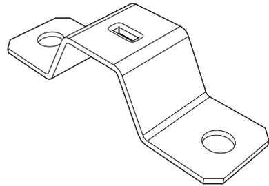
En cas de branchement biphasé et ou triphasé, pour une fixation correcte des câbles, vous devez remplacer le cavalier préinstallé par le cavalier préinstallé par le cavalier fourni à cet effet.
