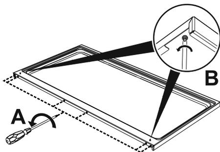
2. Positionnez le dossieret au-dessus de la plaque. Faites correspondre les 6 rainures inférieures du dossieret et les 6 vis situées à l'arrière de la plaque desserrées précédemment.
