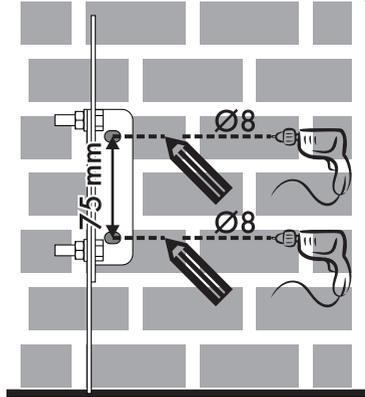
6. Considérez une distance de 50 mm du côté de l'appareil aux trous de la bride.
