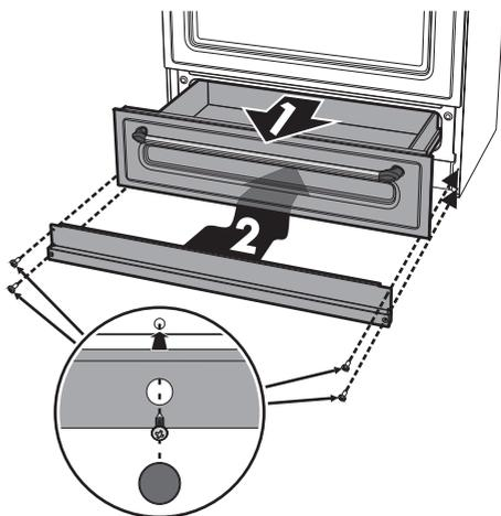
2. Positionnez le socle dans la partie inférieure avant de l'appareil.
