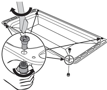
2. Positionnez les supports du tournebroche dans les douilles d'après la figure suivante.
