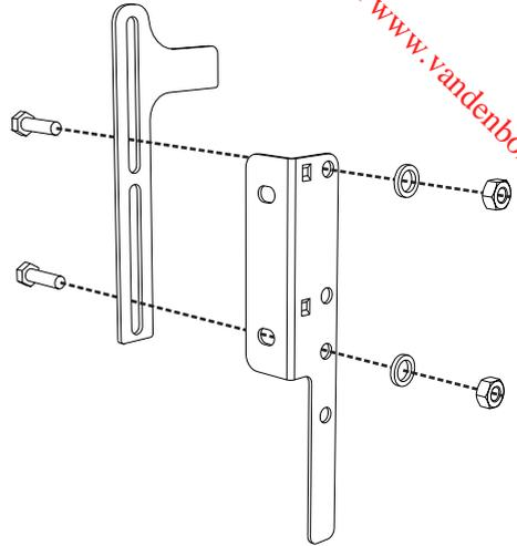
4. Alignez la base du crochet de la bride de fixation sur la base de la coupe de la plaquette de fixation au mur.
